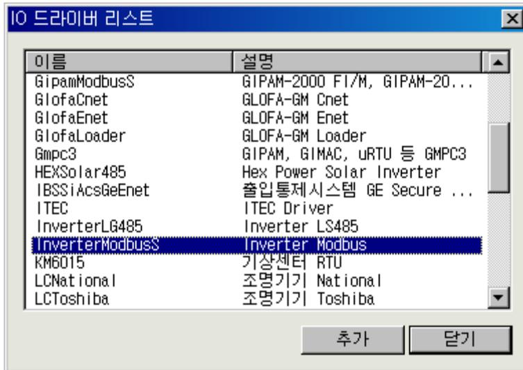
I/O 드라이버 리스트에서 “InverterModbusS” 을 선택한 후 “추가” 버튼을 누릅니다.
