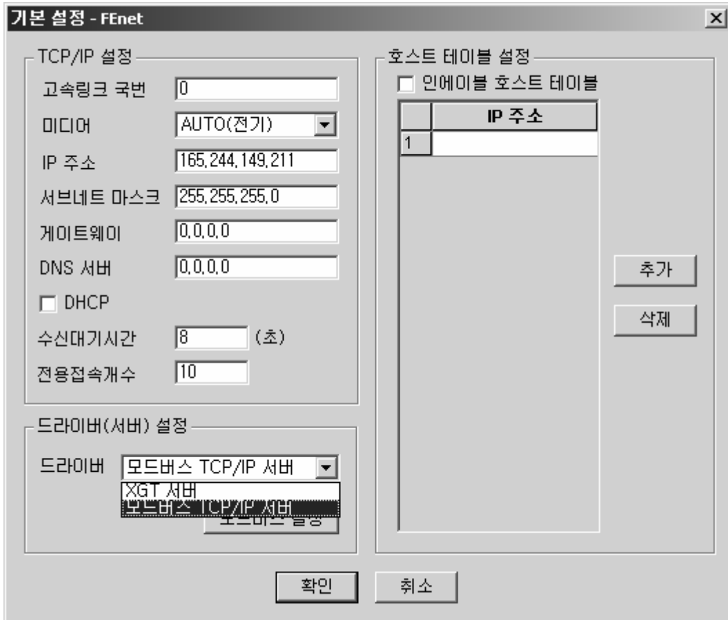
[그림 8.3.1] 모드버스 TCP 드라이버의 설정
