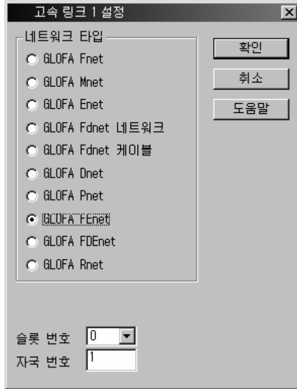
[그림 13.1.23] 고속링크 네트워크 타입 및 슬롯, 국번 설정
