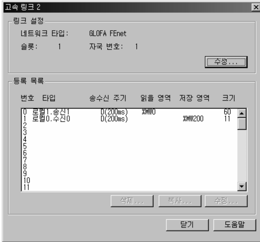
[그림 13.1.27] 고속링크 네트워크 타입 및 슬롯, 국번 설정
