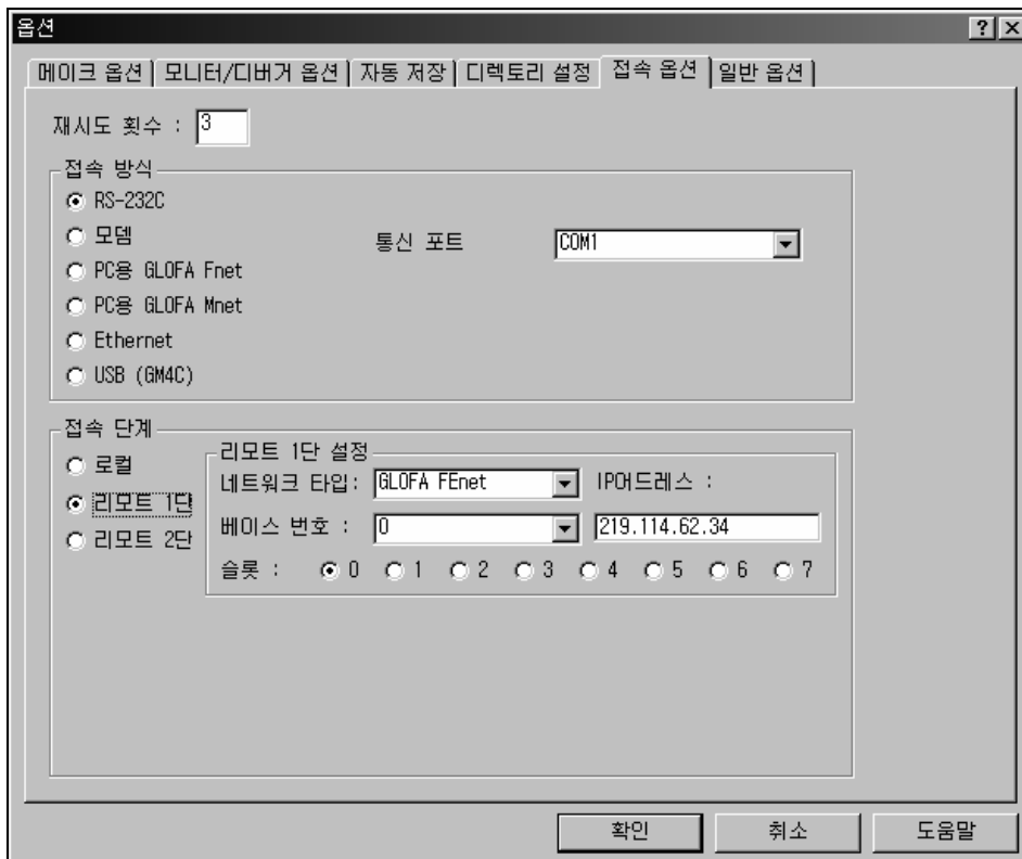
[그림 9.2.3] GMWIN 리모트 1 단 접속(FEnet I/F 모듈의 경우)
