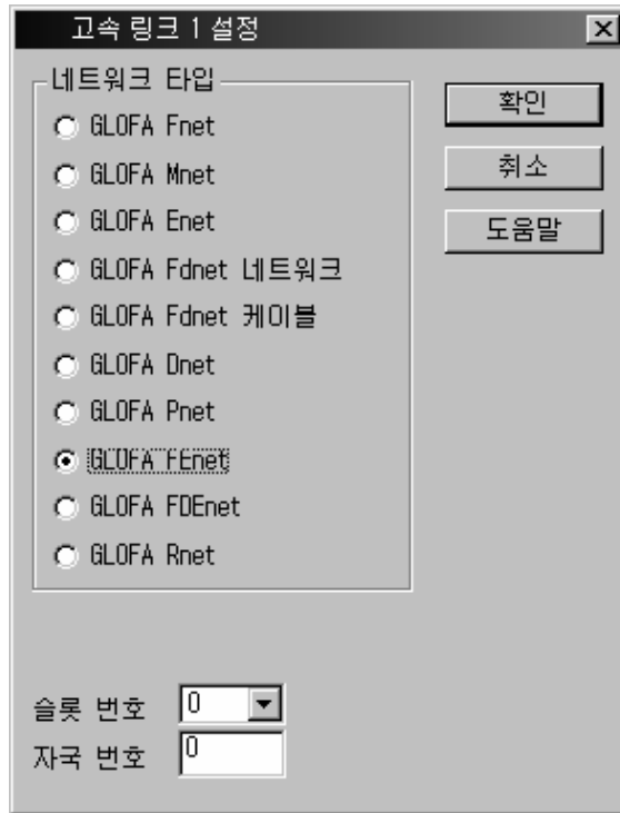
[그림 13.1.15] 고속링크 네트워크 타입 및 슬롯, 국번 설정
